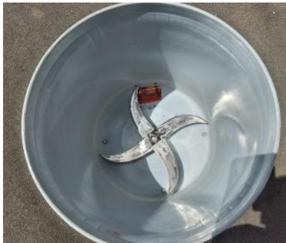
Gambar 5.12 Pemasangan dan Penyesuaian Pisau Potong
