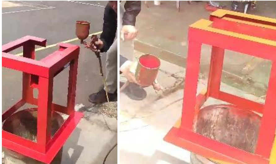
Gambar 5.17 Proses pengecatan permukaan rangka
