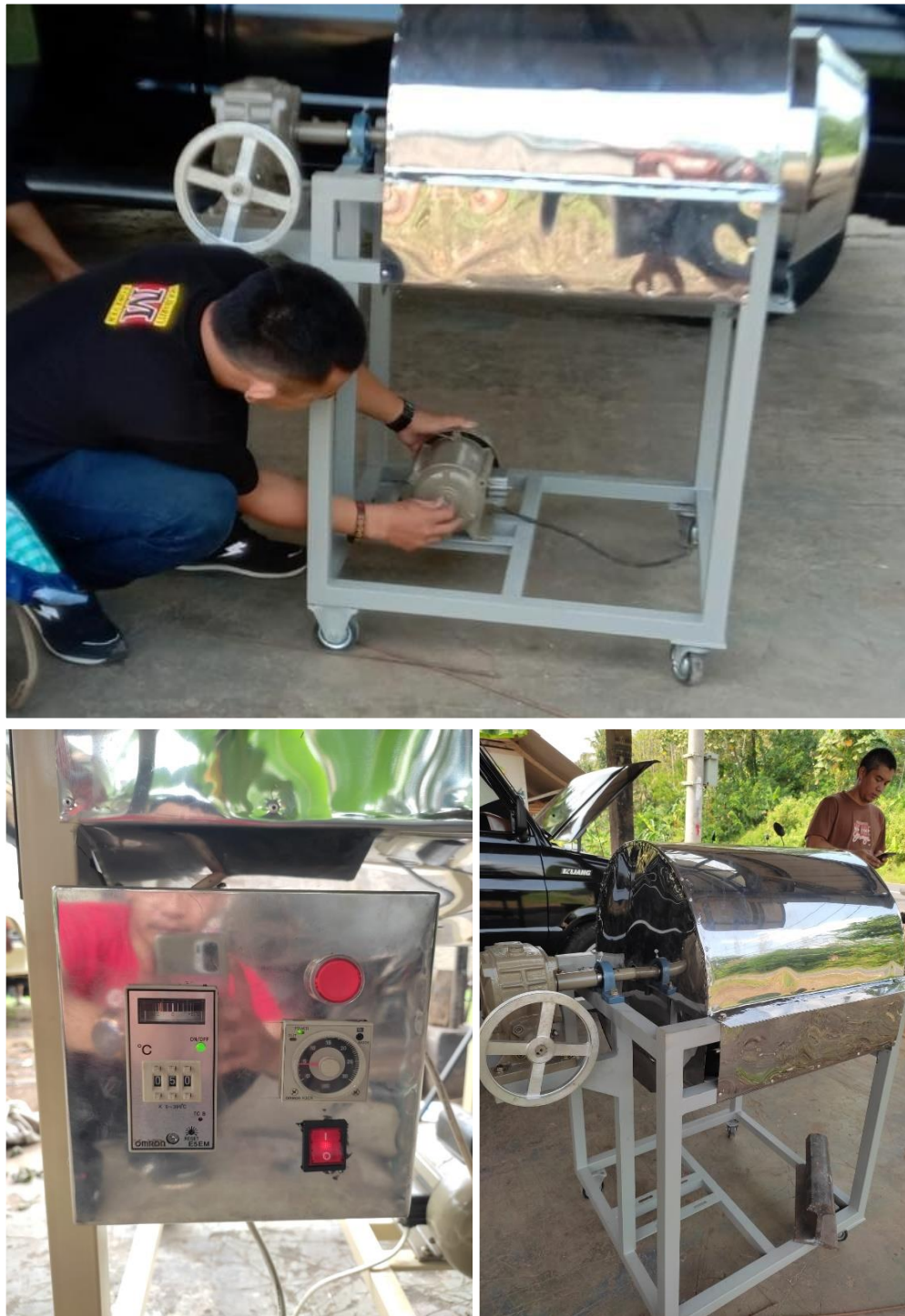
Gambar Pemasangan Panel Box Control
