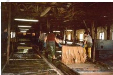
Gambar 4. 13 Proses penyamakan minyak
