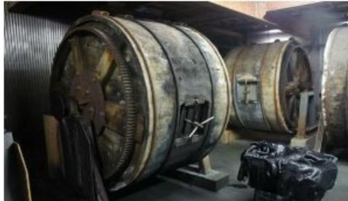
Gambar 4. 14 Drum yang berisi kulit sebagai proses dari penyamakan minyak
