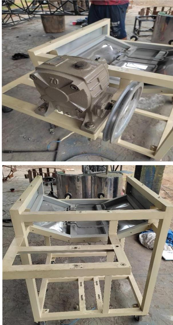
Gambar Perakitan Rangka dan *Gear Box*
