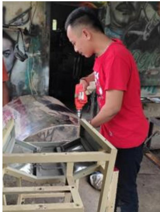
**Gambar 4.13** Proses Pengeboran rangka
