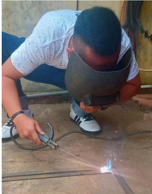
**Gambar 4.11** Pengelasan Rangka
