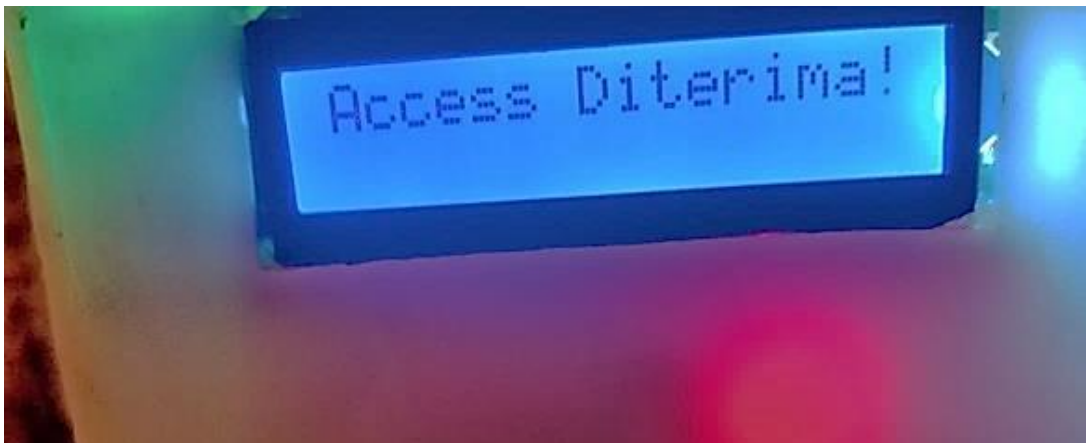
Lampiran 13. Hasil Pengujian RFID kartu terdaftar
