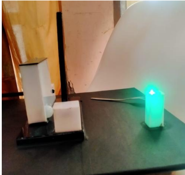
Lampiran 7. Hasil Pengujian Palang pintu gerbang masuk servo tidak bergerak dan led green OFF
