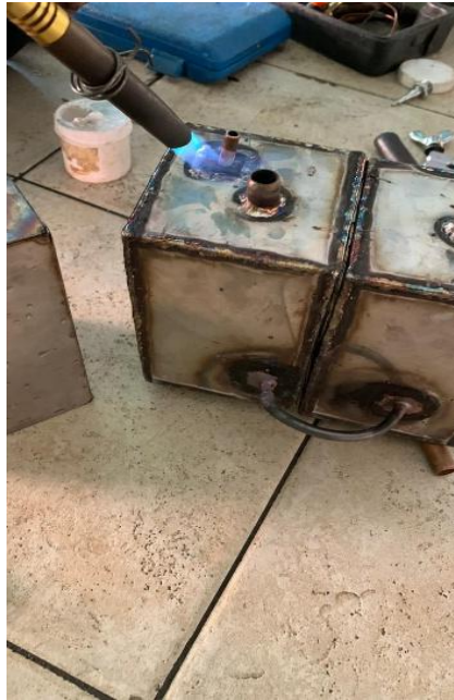
Lampiran 5. Dokumentasi Saat Melakukan Pengelasan Pipa Tembaga
