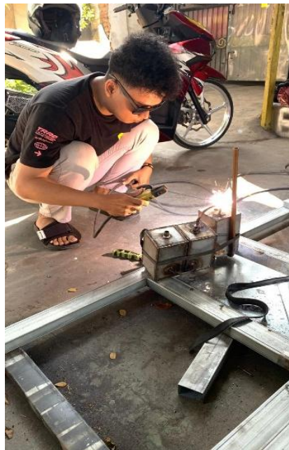
Lampiran 6. Dokumentasi Saat Melakukan Pengelasan Tabung Final
